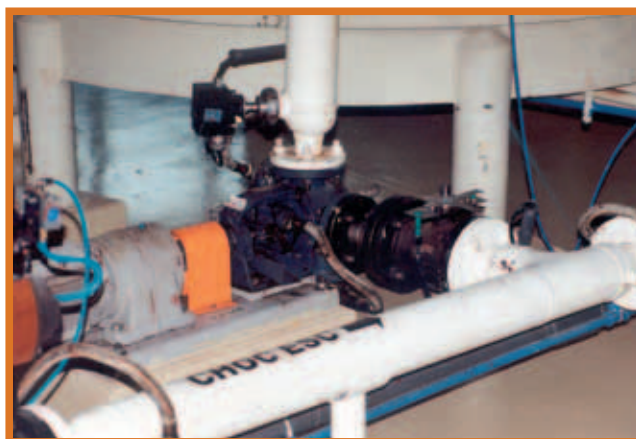
Pompa per cioccolato in uno stabilimento in Brasile Chocolate pump in a factory in Brasil
